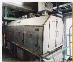
⑫ 分別機 一次発酵した堆肥を返送チップ・返送粉体および製品に分けます。
