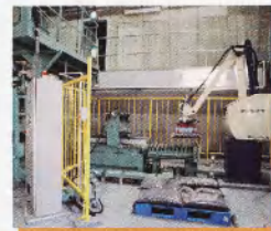
⑭ 袋詰装置&ロボットパレタイザ 袋詰め作業からパレットに積み一連の作業は自動で行います。
