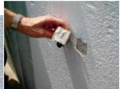
付着強度を調査する。4cm角のアタッチメントをエポキシ樹脂で壁面に接着し、強度が発揮された段階で引っ張る。躯体、下塗り材、中塗り材、上塗り材の層構成や破断箇所、付着強度などを確認する
