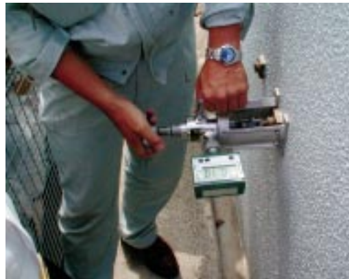
付着強度を調査する。4cm角のアタッチメントをエポキシ樹脂で壁面に接着し、強度が発揮された段階で引っ張る。躯体、下塗り材、中塗り材、上塗り材の層構成や破断箇所、付着強度などを確認する
