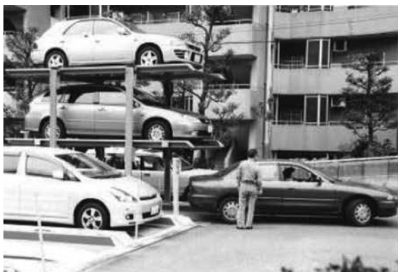
安全装置が不十分な古い形式の機械式3段駐車装置。
